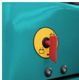
Numerosos dispositivos, como el sensor del asiento y el interruptor de corte de corriente, garantizan funcionalidad asegurando la máxima tutela del operador.
