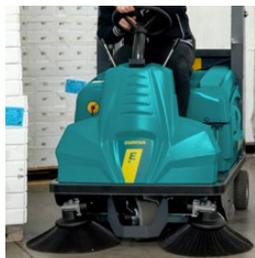
La conducción similar a la de un automóvil, la gran visibilidad y el radio de giro de tan solo 1.050 mm hacen de la Rider Lift una máquina extremadamente ágil y versátil.
