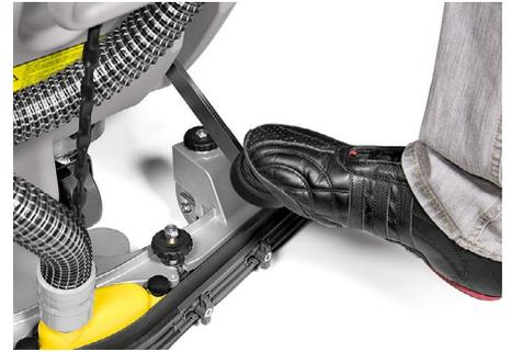
La cadena de bajada de la boquilla de aspiración es robusta, está realizada en acero y dotada de un mango ergonómico de aluminio moldeado a presión
