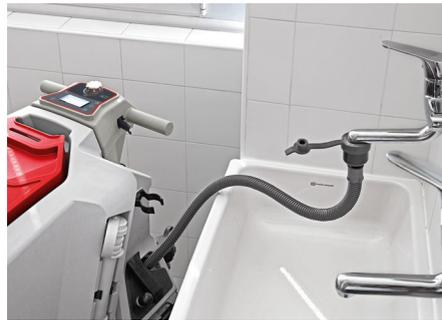
El tubo de llenado del tanque solución se puede conectar directamente a cualquier grifo, ofreciendo la posibilidad de llenarlo en cualquier parte y agilizar así la operación
