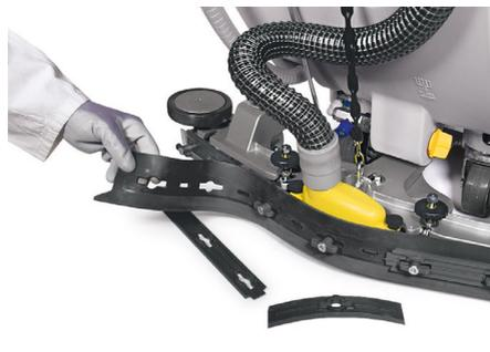
Las operaciones de sustitución y rotación de las gomas de la boquilla de aspiración se realizan en pocos instantes y no requieren el empleo de herramientas
