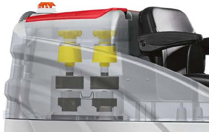
Los motores de aspiración están aislados dentro de una cámara de doble pared que reduce notablemente el nivel de ruido, para trabajar de modo discreto y silencioso y proteger así la salud del operador.
