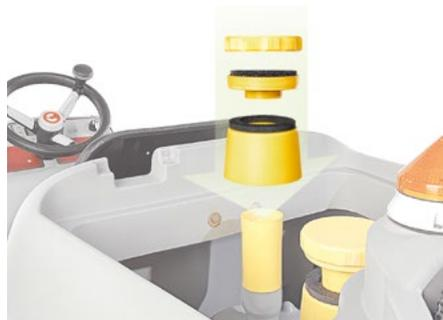
El filtro solución está en una zona de fácil acceso y el flotador/filtro de aspiración se desmonta en un instante, de modo que resultan más sencillas y rápidas las actividades de limpieza de la máquina al final de la intervención.
