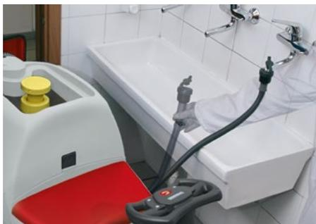
Rellenado rápido del depósito solución
