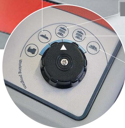
Utilizar la C130 es muy fácil, intuitivo y práctico. Con el selector de los programas de trabajo, se puede seleccionar manualmente el tipo de actividad que se quiera realizar: lavado y secado, lavado y secado con bancada desplazante o bien sólo lavado o sólo secado.
