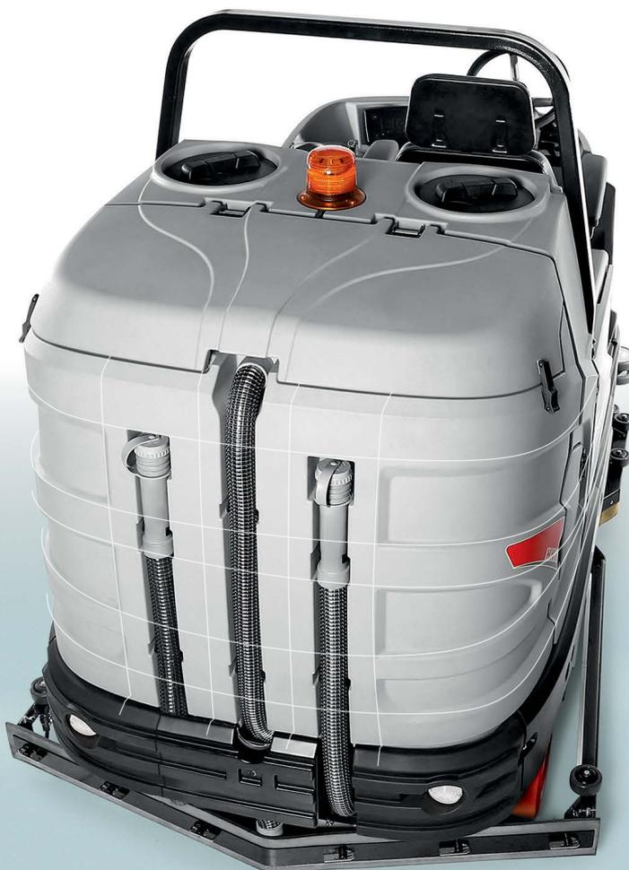
Ningún componente queda expuesto, incluso los tubos de vaciado de los tanques (solución y recuperación) y de aspiración están situados en zonas protegidas.
