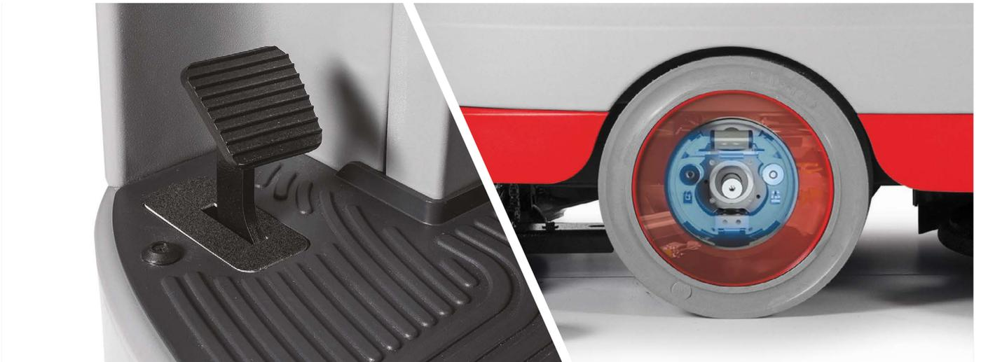
Optima está equipada con un freno hidráulico que funciona en las ruedas traseras, para aumentar la seguridad y el confort. El freno electrónico en la rueda delantera del motor funciona como freno de emergencia o de estacionamiento.
