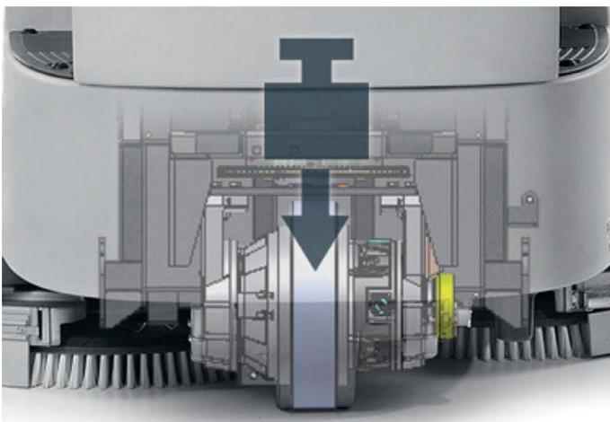
Para obtener la máxima efectividad, Optima puede ser equipada con el kit de rampas que permite aumentar el agarre de la rueda delantera, mejorando el rendimiento mientras sube posibles rampas. Gracias al peso extra la carga se distribuirá de tal forma que se evite el deslizamiento de la rueda motriz.
