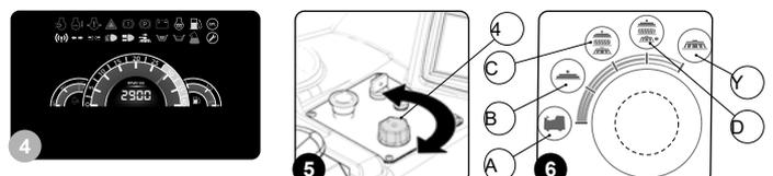
7. Abrir el paso de la solución detergente en la instalación hídrica de la máquina girando la palanca de mando del grifo (5) en el sentido indicado por la flecha (Fig. 7).
