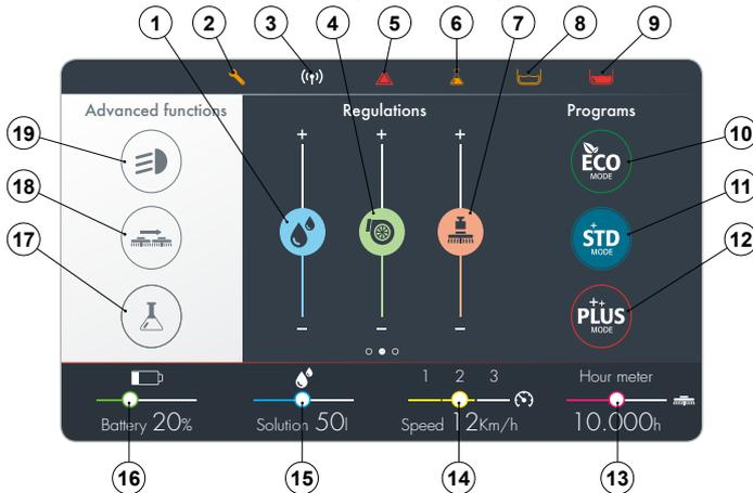
1. Indicador de regulación del flujo de la solución detergente en la instalación hídrica de la máquina.
