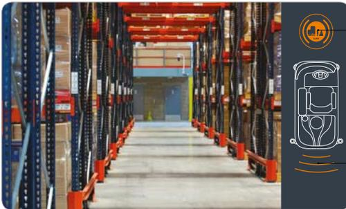
**NOTA:** si la máquina posee cámara trasera, acoplado la marcha atrás se visualiza en la pantalla de mando la imagen de la cámara conectada y en el lado derecho de la pantalla se puede ver el perfil estilizado de la máquina.
