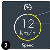
**i** **NOTA:** En el interior del símbolo (2) se visualiza la velocidad instantánea (3) de la máquina en kilómetros por hora (Fig.2).
