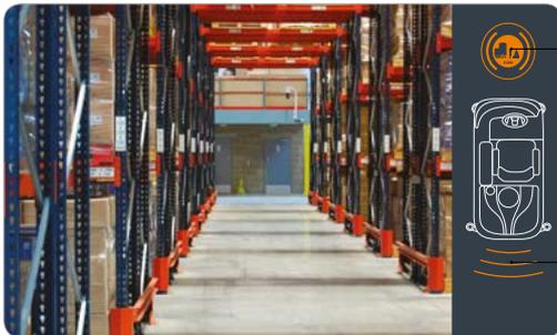
**NOTA:** si la máquina posee cámara trasera, acoplando la marcha atrás se visualiza en la pantalla de mando la imagen de la cámara conectada y en el lado derecho de la pantalla se puede ver el perfil estilizado de la máquina.
