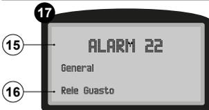
Cuando se presenta un error, en la pantalla de control se visualizará el símbolo correspondiente la página de alarma (Fig. 17). La alarma se visualiza mediante una primera línea intermitente referida al código (15) y al origen del error (16) (Fig. 17), mientras que la segunda línea visualiza una síntesis (18) de la descripción del error.
