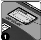
En el panel de mando de la máquina hay una pantalla del contador de horas (1) que permite observar el tiempo total de uso (Fig. 1). Las cifras antes del símbolo "." identifican las horas, mientras que la cifra que lo sigue identifica los decimales de hora (un decimal de hora corresponde a seis minutos). Cuando parpadea el símbolo "." significa que el contador de horas está contando el tiempo de funcionamiento de la máquina.
