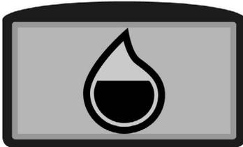
La imagen de al lado identifica la "REGULACIÓN DEL NIVEL DE LA CANTIDAD DE AGUA" en el circuito de la instalación hídrica (versiones con sistema CDS).
