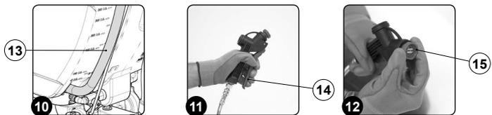
12. Limpiar la cámara de aspiración del cuerpo de la boquilla de aspiración con un chorro de agua y después con un trapo húmedo.
